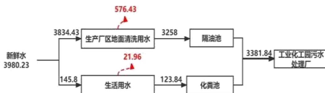
图 3-4 本项目环评阶段水平衡图（单位：t/a）
